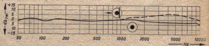
Frequenzgang des „unsichtbaren“ Tauchpulkmikrofons des Laboratoriums Wennebostel. Durch Aufsetzen der Plexiglasscheibe wird die Empfindlichkeit für den von vorn auftreffenden Schall oberhalb von 1000 Hz erhöht. Die mittlere Empfindlichkeit (Absolut) beträgt 0,08 mV/ $\mu$ bar an 200 Ohm
