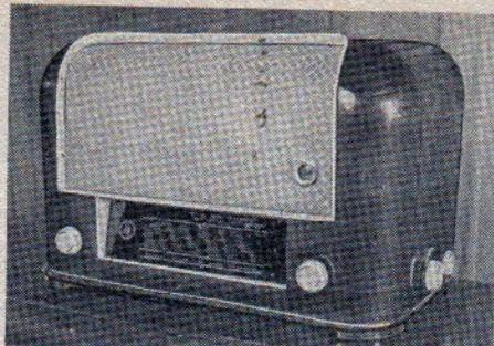
Links Lorenz „Stuttgart“, ein Einkreisempfänger mit der UEL 71. Rechts Metz „Diplomat 1“, ein Gerät mit 2 Lautsprechern, Magischem Auge und eigenwilligem Gehäuse
