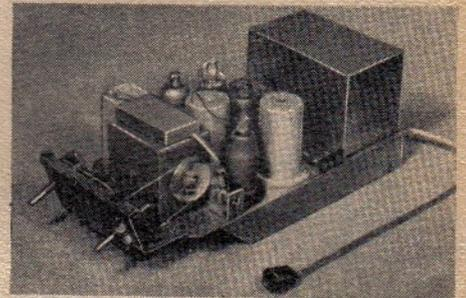
Chassis des 6-Kreis-Auto-Supers der Firma Rada-Rundfunkgeräteelektrotechnik GmbH., Mannheim
