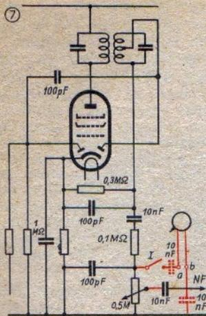
In dieser oder ähnlicher Weise wird der Tonabnehmer bei Geräten mit einstufiger Niederfrequenz-Verstärkung angeschlossen werden können. Es ist zu beachten, daß nicht immer, wenn man eine Duodiode-Endpentode antrifft, die Nie-
