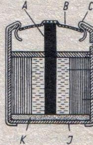
A Kohlestab, B verzinnter Deckel (+ Pol), C umgebogener Isolierrand, D Ventil, E Abdichtung, F Depolarisator (HgO und Kohlepulver in Beutel), G Polyvinyl-Umhüllung, H in Kalilauge getränktes Zinkpapier, J Zinkgefäß, K Isolierscheibe
