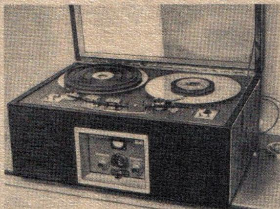
Minuten vor dem Ende der Drahtrolle flackert eine Glühlampe als Signal auf. Der Frequenzbereich wird mit 150...5000 Hz, also voll ausreichend für Sprache, angegeben. Mit Hilfe einer Fernsteuerstelle (Kommandogerät) ist Fernbedienung möglich.
