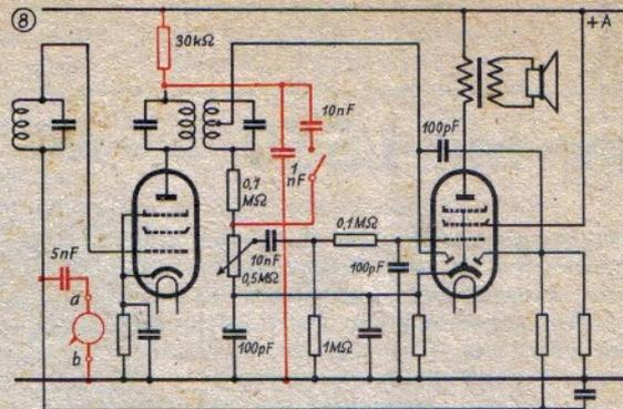
derfrequenz einstufig verstärkt wird. Häufig liegt dann eine Reflexschaltung vor, oder es wird ein System einer Verbundröhre für die erste NF-Verstärkung verwendet. Das ist z. B. der Fall bei der Bestückung UCH 21, UCH 21, UBL 21, bei der das H-System der zweiten Röhre für die Zwischenfrequenz, das C-System für die NF-Verstärkung benutzt wird.
