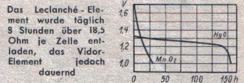
Abb. 2. Vergleich der Entladungskurven eines Vidor-Elements mit einem Leclanché-Element
